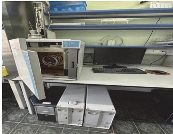
Рисунок 14 — Прибор для аппаратного программирования компонентов для определения концентрации КЖК в биосубстрате методом газожидкостной хроматографии
