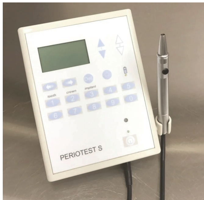
Рисунок 2.9 — Прибор для оценки резервных возможностей пародонта зубов «Periotest S» (Medizintechnik Gulden, Германия)
