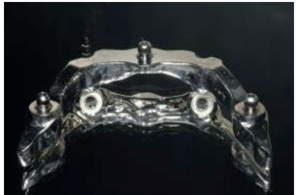
Рисунок 82 – Преждевременный износ сферических патриц, который не компенсировать заменой матриц на более жесткие
