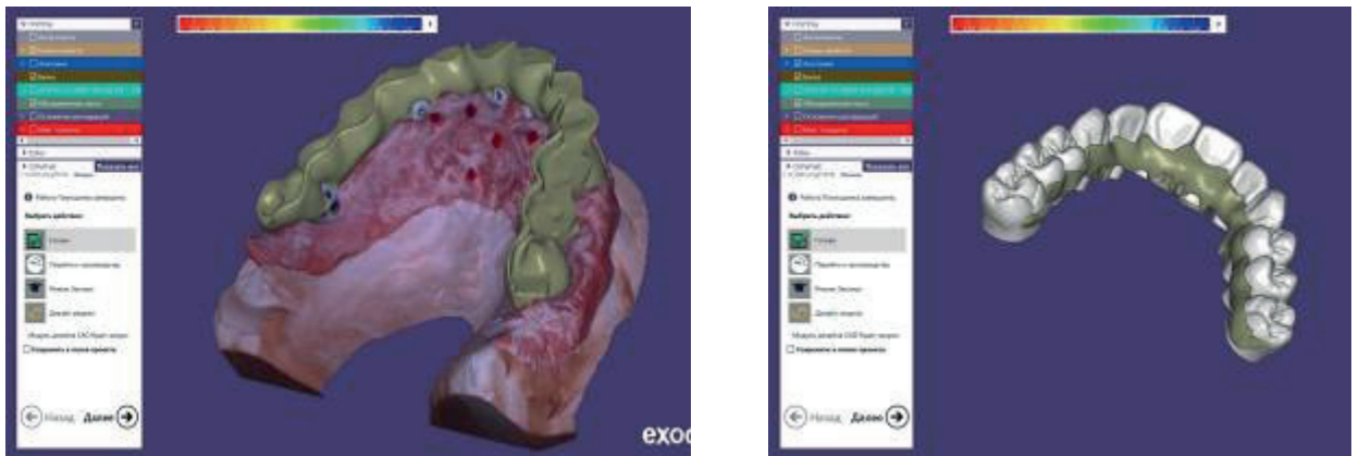
Рисунок 61 – Цифровая модель с созданным в программном комплексе Exocad каркасом имплантационного протеза верхней челюсти
