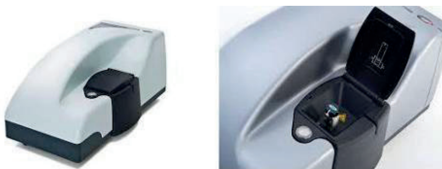
Рисунок 2.2 — Анализатор «Malvern Zetasizer Nano ZS»
