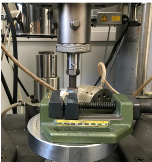
Рисунок 21 — Проведение определения силы адгезионной прочности на сдвиг на универсальной испытательной машине Instron
