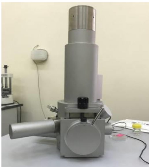
Рисунок 19 — Сканирующий электронный микроскоп TESCAN VEGA 3 SBH в лаборатории наномеханических испытаний ФГБНУ «Технологический институт сверхтвердых и новых углеродных материалов»
