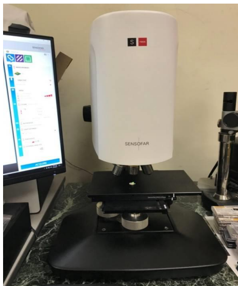
Рисунок 18 — Конфокальный микроскоп Sensofar S neox, установленный в лаборатории наномеханических испытаний ФГБНУ «Технологический институт сверхтвердых и новых углеродных материалов»
