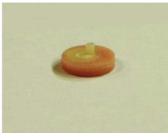
Рисунок 6 — Столбик из композитного материала, фиксированный на подготовленный образец прессованной керамики
