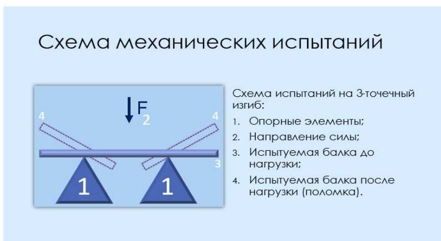
Рисунок 1 — Схема испытаний на трехточечный изгиб
