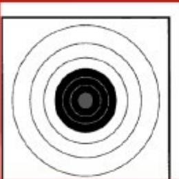
**Рис. 2.13.** Мишень для контроля положения луча лазерного диода
